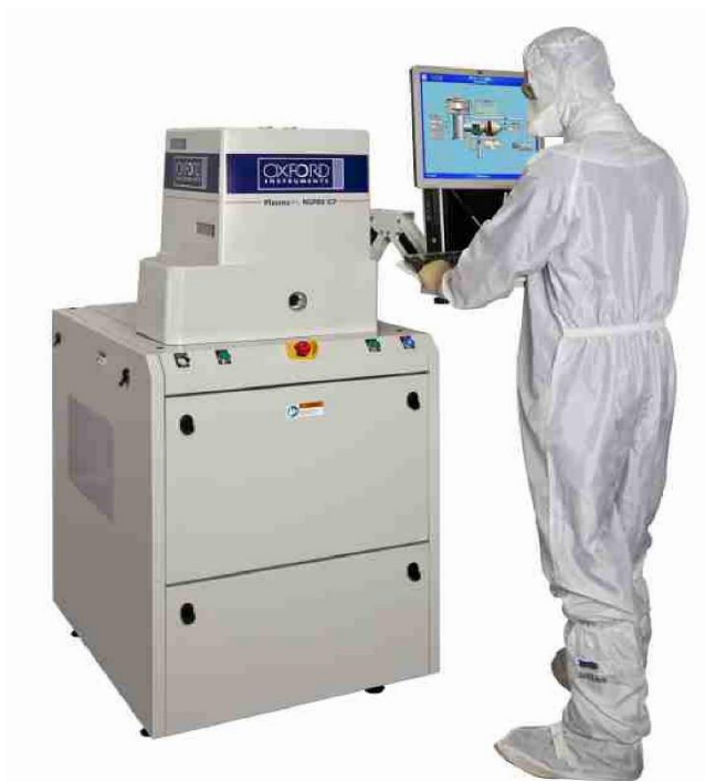
Abbildung 11: Oxford NGP80 Abscheideanlage, entnommen aus [25]
